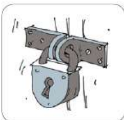
Препятствие для свободного открывания дверей на путях эвакуации
